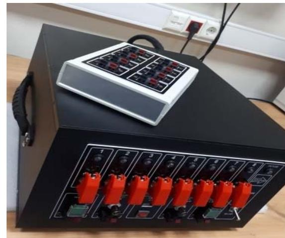
Рис.1 Внешний вид устройства запуска ПП-008
