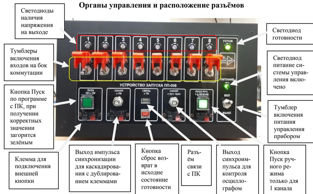
Рис.2 Органы управления и расположение разъёмов на передней панели основного блока
